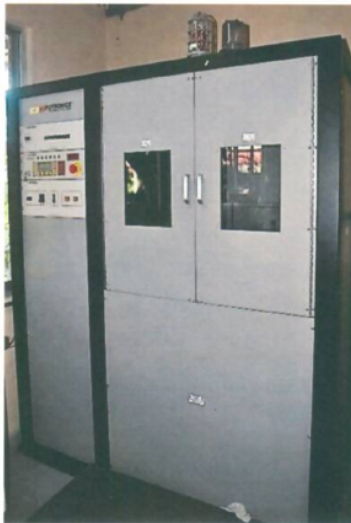
Fig. 1. Medidor de rigidez dieléctrica marca Hipotronics Modelo 970 Control interface
